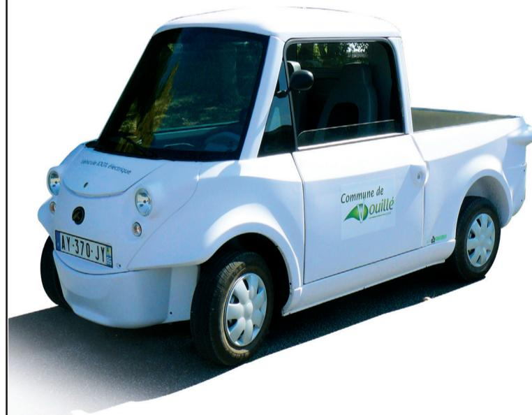
La Commune de Vouillé procède au renouvellement de son parc automobile **par des véhicules électriques de la société Eco & Mobilité implantée à Chauvigny. Le premier véhicule appelé Simply city pick up a été livré le 30 juillet dernier.** Il s'agit d'un Pickup **100% électrique** d'une puissance de 8 kW et d'une charge utile de 550 kg. Il peut atteindre une vitesse de 80 km/h avec une autonomie pouvant aller jusqu'à 80 Km. **Son coût de consommation est estimé à 1€/100 km.**
